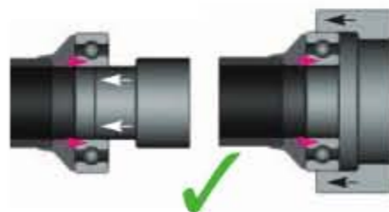
使用正確的工具可以完全避免滾珠或溝槽的損傷
